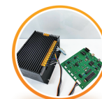
线性电源及 控制电路
